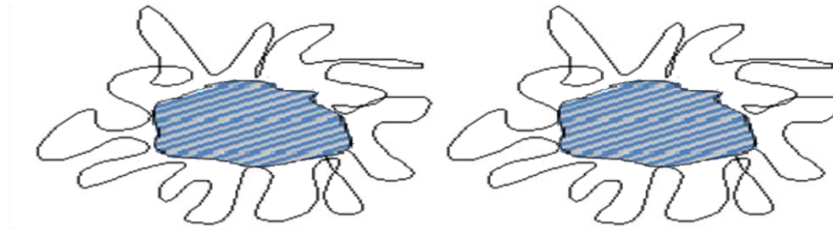
Şekil 2.13. Sterik stabilizasyonun şematik gösterimi.
