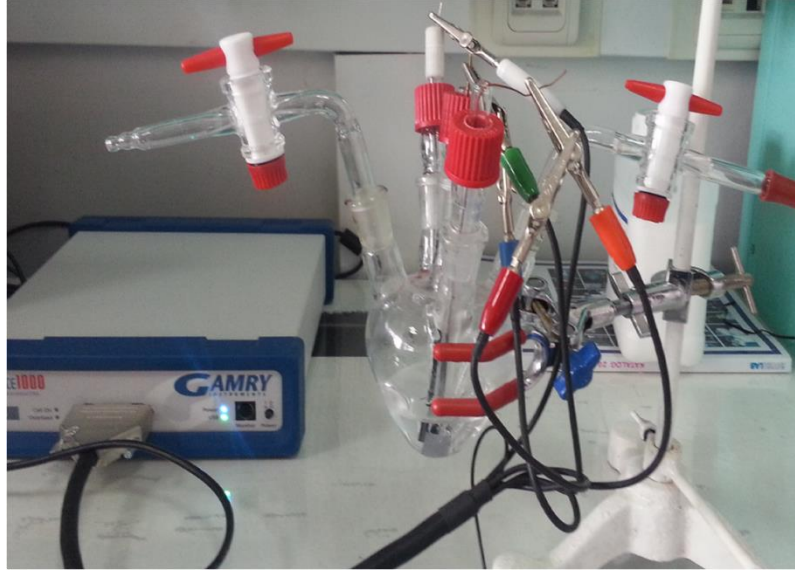
Şekil 3.4. Elektrokimyasal ölçümlerin gerçekleştirildiği hücre.
