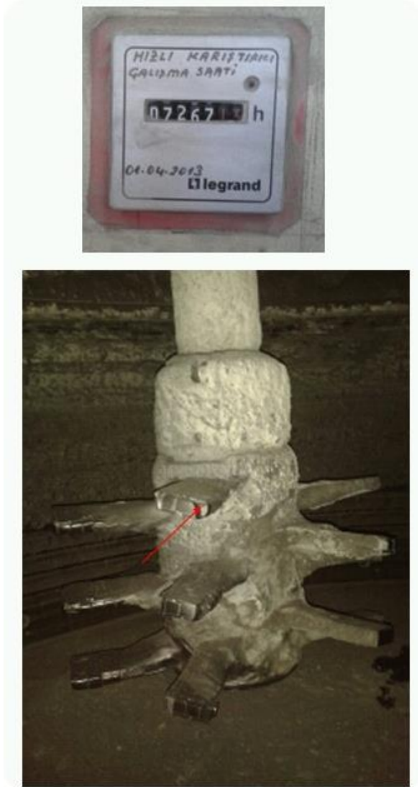
Şekil 7.6. Çalışma saati: 7267 – WC Plakaların aşınma durumu (bıçak uçlarında aşınma belirtileri).
