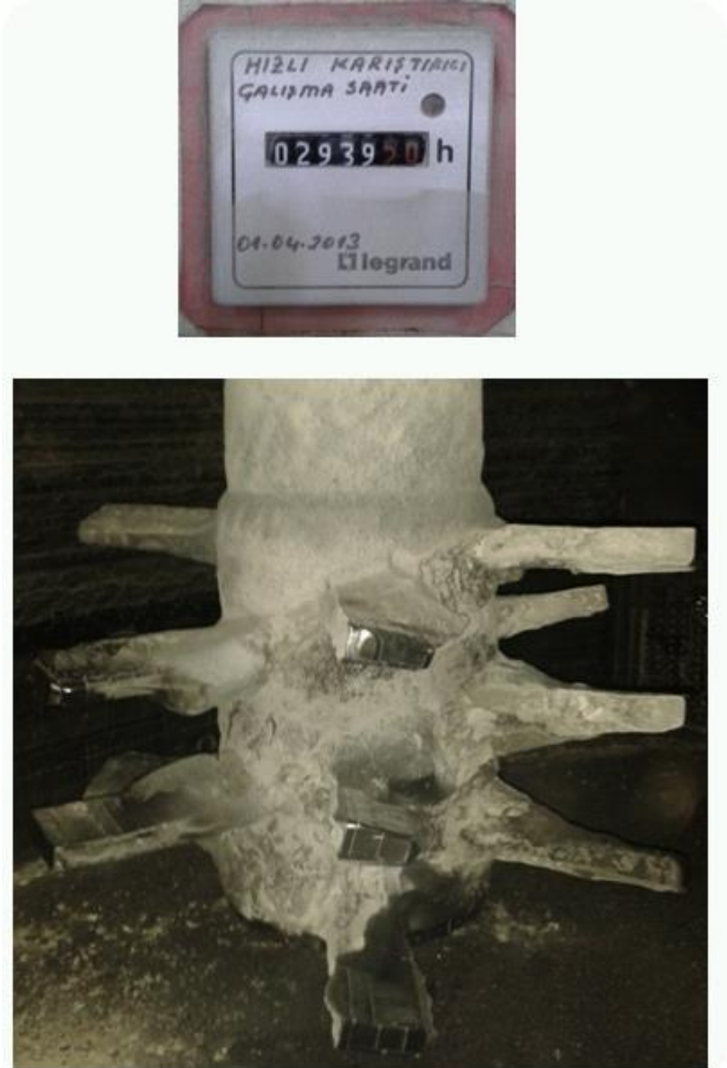
Şekil 7.3. Çalışma saati: 2939 Karıştırıcının durumu (aşınma başlangıçları).
