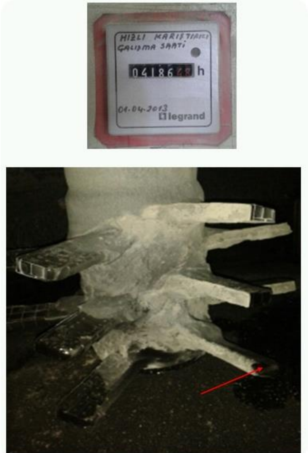
Şekil 7.4. Çalışma saati: 4186 WC kaplı bıçak uçlarında aşınma.
