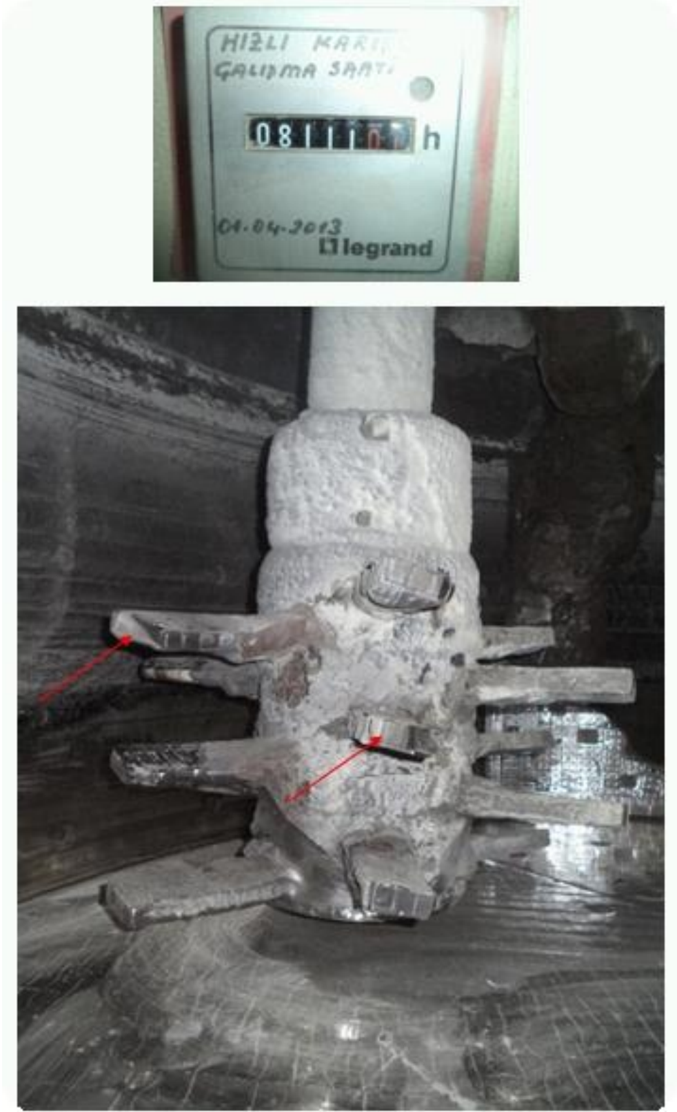
Şekil 7.8. “8111” saat sonunda, WC Plakaların aşındığını gösteren görüntüler.
