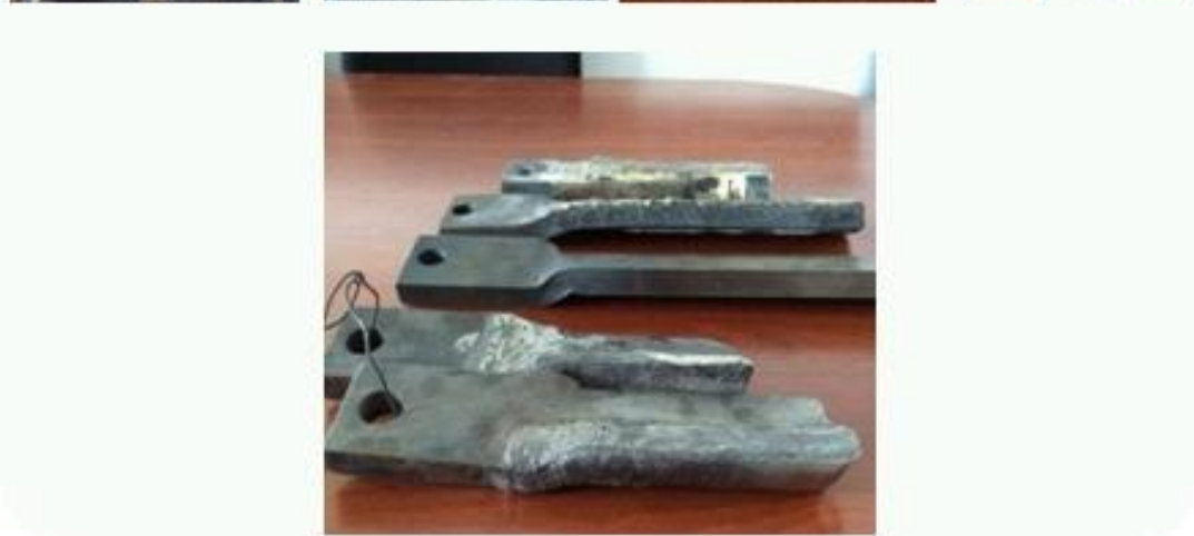
Şekil 6.26. Servis şartları için hazırlanmış test numune seti (408 saat sonunda aşınarak testten çıkan CrC numune işaretlenmiş olarak).
