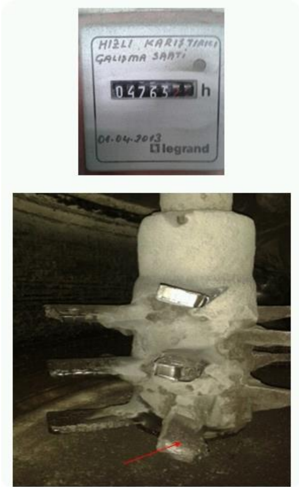
Şekil 7.5. Çalışma saati: 4765, WC Tel kaplamanın aşındığını gösteren görüntü.
