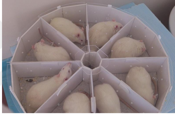
Şekil 3.3. 1800 MHz elektromanyetik alan uygulanırken düzeneğin içine yerleştirilmiş sıçanlar.
