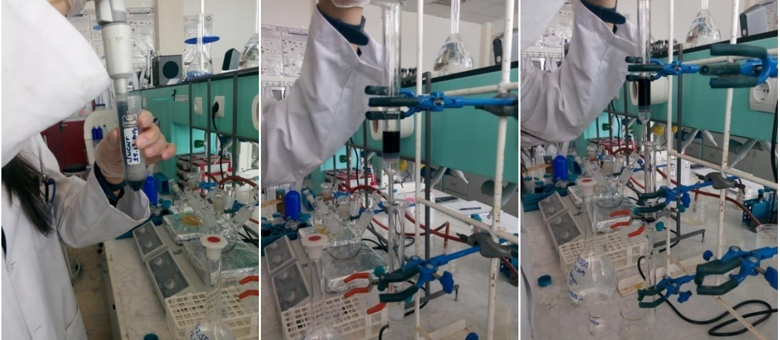
Şekil 3.4. Hazırlanan tek duvarlı CNT’nin kolonlara ilave edilmesi.
