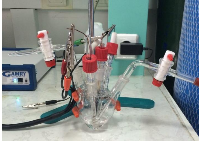
Şekil 3.10. Elektrokimyasal ölçümlerin alındığı üçlü elektrot sistemi.
