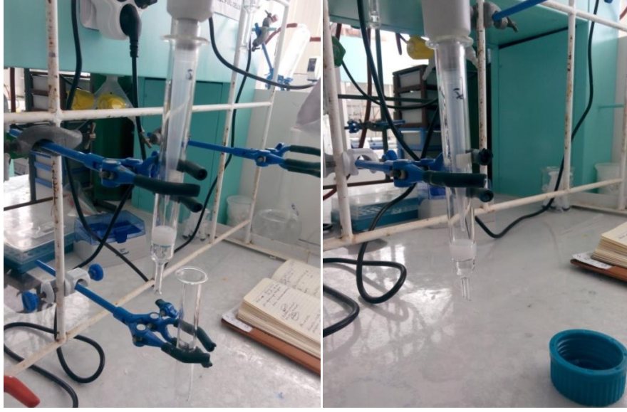
Şekil 3.3. Jelin kolon sistemine yerleştirilmesi.
