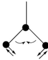
Şekil 3.5. Makaslama titreşim ( \delta_s ) hareketi.
