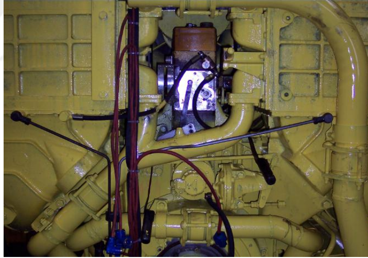
Şekil 7.17 Ara soğutucu üzerinde sıcaklık ölçüm noktaları.
