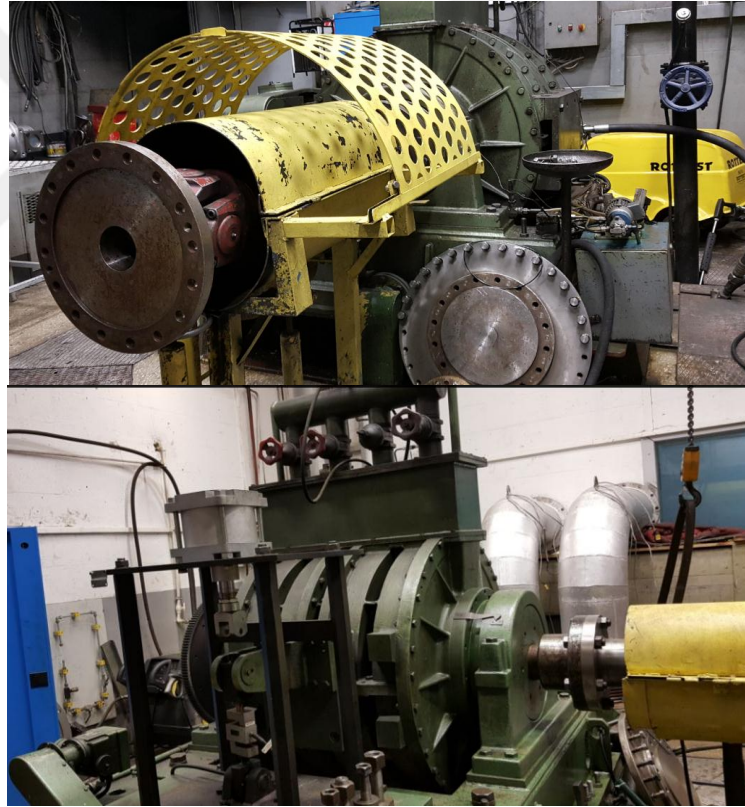
Şekil 7.9. Motor test ünitesinde bulunan dinamometre.
