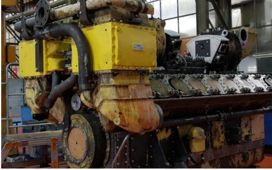
Şekil 6.6. 16 PA4 V185 dizel motor ara soğutucu bağlantıları.
