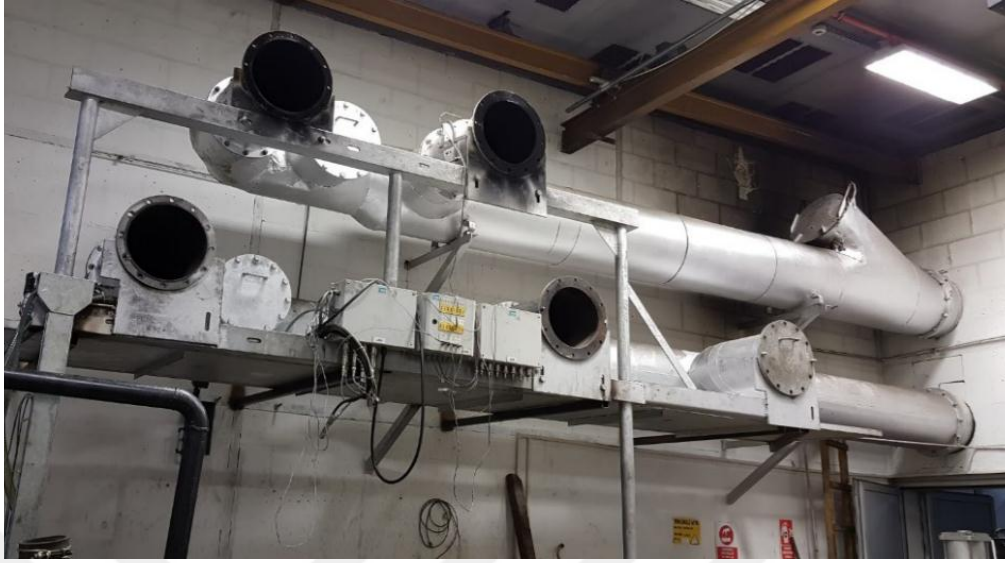
Şekil 7.12. Motor test ünitesi test motorunun emisyon çıkış boruları.
