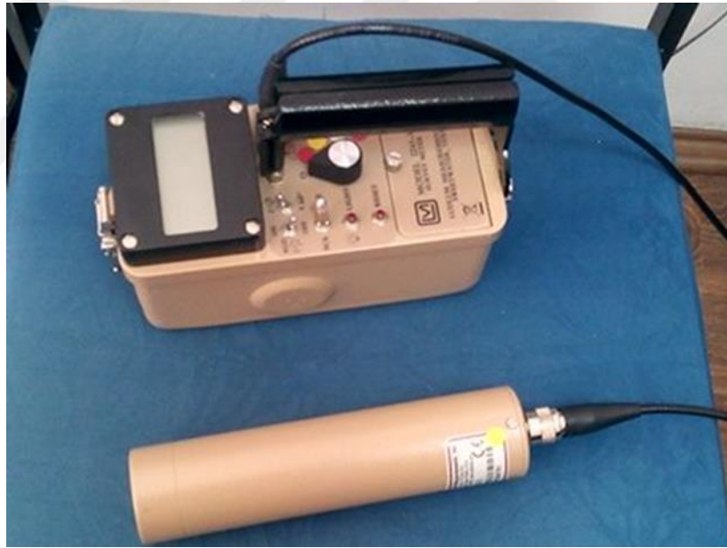
Şekil 3.2. LUDLUM 2241-3RK seyyar NaI(Tl) sintilasyon dedektörü ve sayım sistemi.
