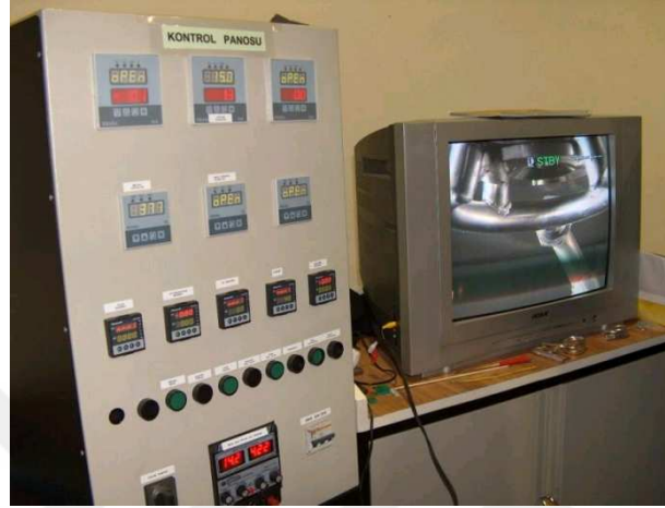
Şekil 3.3. Kontrol panosu ve atomizasyon takibi (Ünal ve Aydın, 2008).
