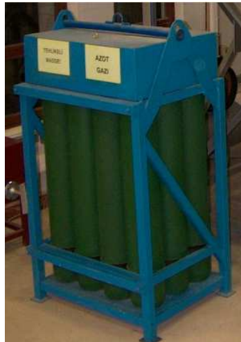
Şekil 3.4. 12 ayrı tüpten oluşan yüksek basınçlı gaz sistemi (Ünal ve Aydın, 2008).
