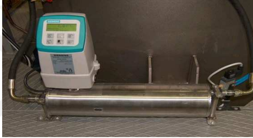
Şekil 3.5. Kütleli debi ölçüm cihazı (Ünal ve Aydın, 2008).
