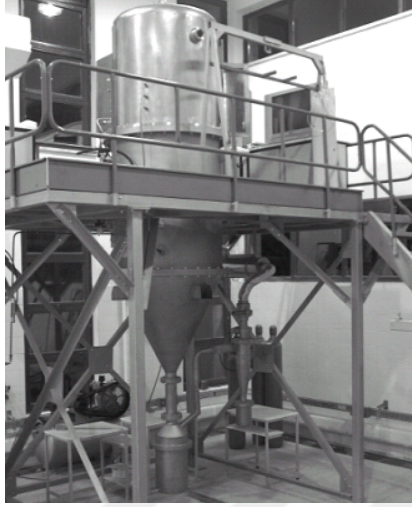
Şekil 3.1. Dumlupınar Gaz Atomizasyon Ünitesi (Aydın ve Ünal, 2007).
