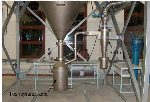
Şekil 3.9. Toz toplama kabı ve siklonun görünümü (Ünal ve Aydın, 2008).
