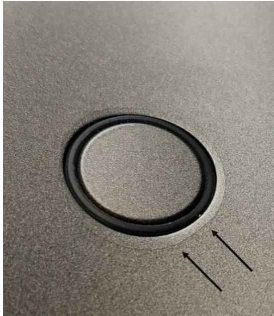
Şekil 11.10: Görsel yüzeyde çatlaklar.
