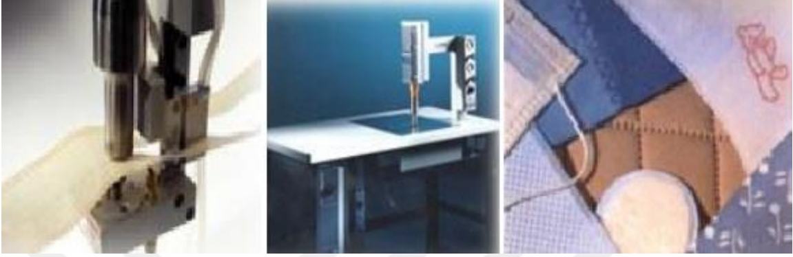
Şekil 8.12: Ultrasonik kaynak yöntemi kesme ve kumaş dikme uygulaması [14].
