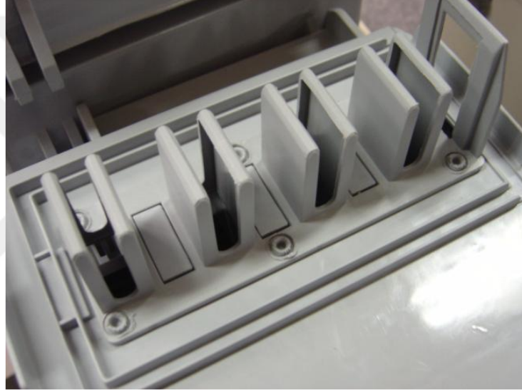
Şekil 8.9: Ultrasonik kaynak yöntemi perçin başı ezme uygulaması [14].
