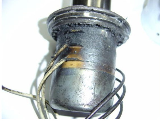
Şekil 8.15: Hasar görmüş enerji dönüştürücü (conventer) [12].
