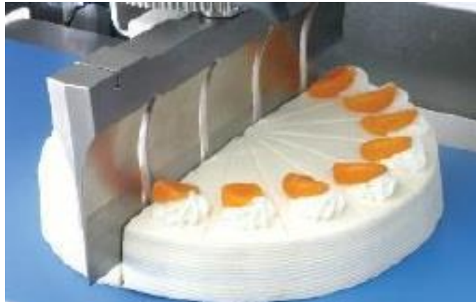
Şekil 8.13: Gıda maddelerin ultrasonik kaynak yöntemi kesme uygulaması [14].
