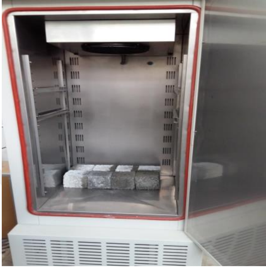
Şekil 4.8. Donma-Çözülme Tayini Deney Düzeneği.
