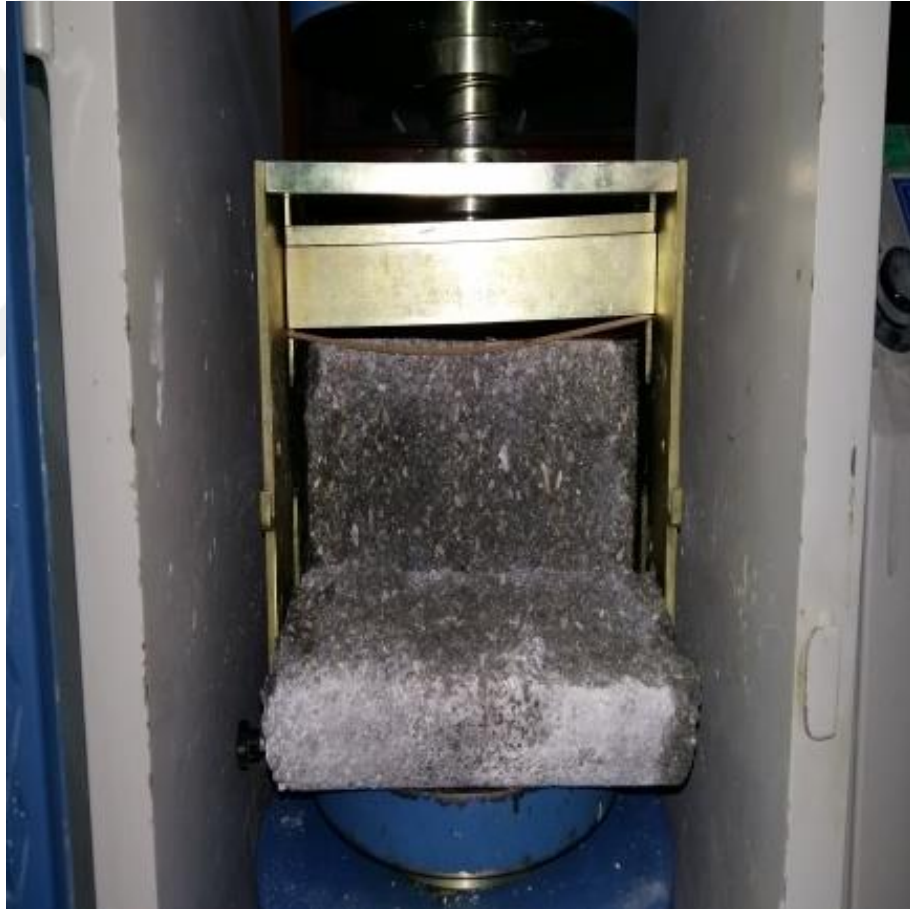
Şekil 4.5. Yarmada Çekme Dayanımı Tayini Deney Düzeneği.
