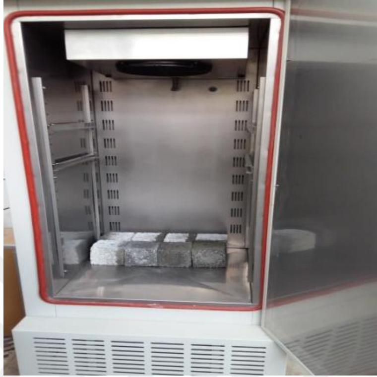
Şekil 4.9. Kimyasal Maddelere Karşı Dayanıklılık Tayini Deney Düzenegi.
