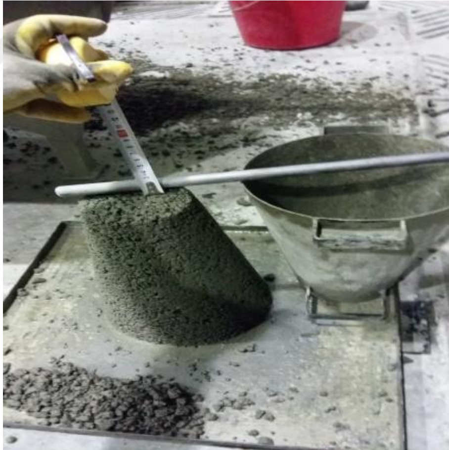
Şekil 4.1. Slump Deneyi Düzeneği.
