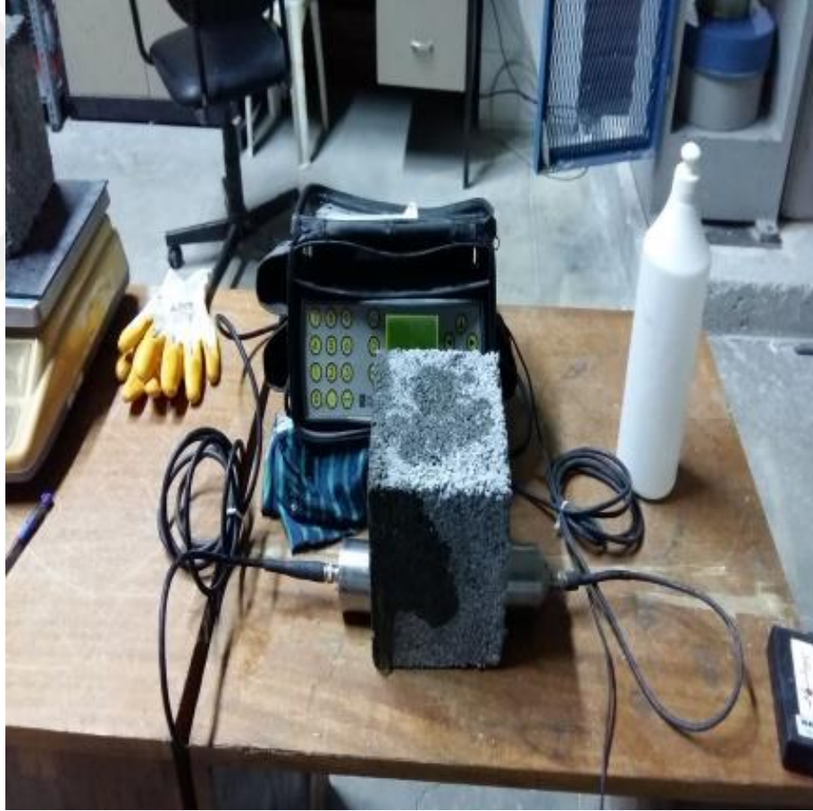
Şekil 4.3. Ultrases Geçiş Hızı Tayini Deney Düzenegi.
