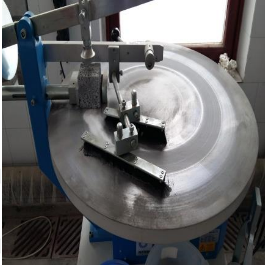
Şekil 4.7. Aşınma Dayanımı Tayini Denei Düzeneđi.
