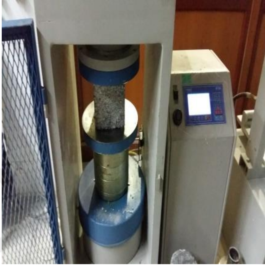
Şekil 4.4. Basınç Dayanımı Tayini Deney Düzeneği.
