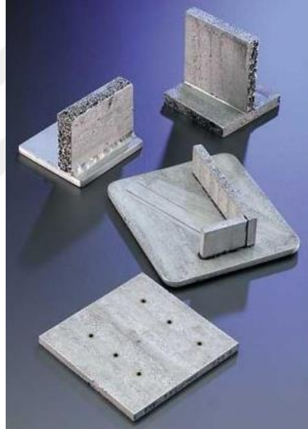
Şekil 6.43. Alüminyum köpük montaj yöntemleri (European Aluminium Association, 2002).
