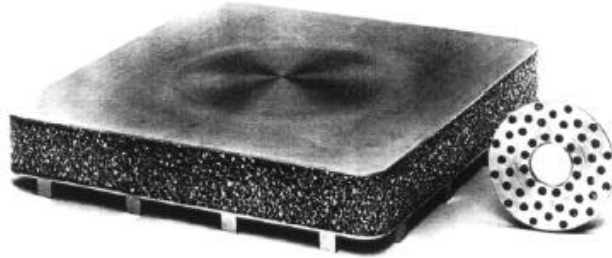
Şekil 5.8. Kompozit ayna (Düşük yoğunluklu) yapımında yararlanılan köpük.
