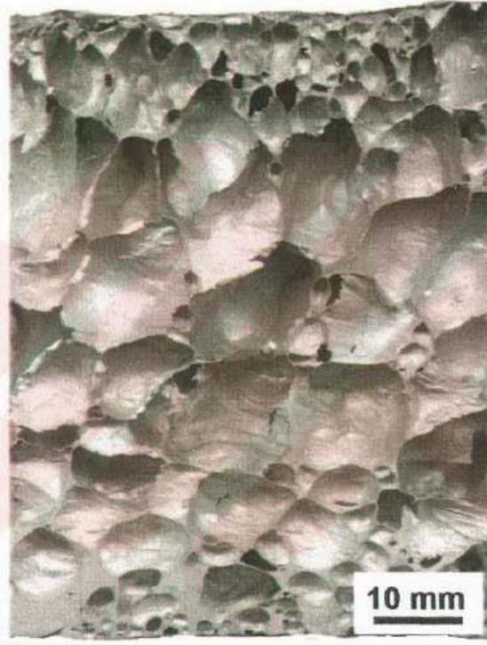
Şekil 3.4. Gaz enjekteli yöntemi ile ortaya çıkartılan köpük metalin hücre yapısı (Prakash vd., 1995).
