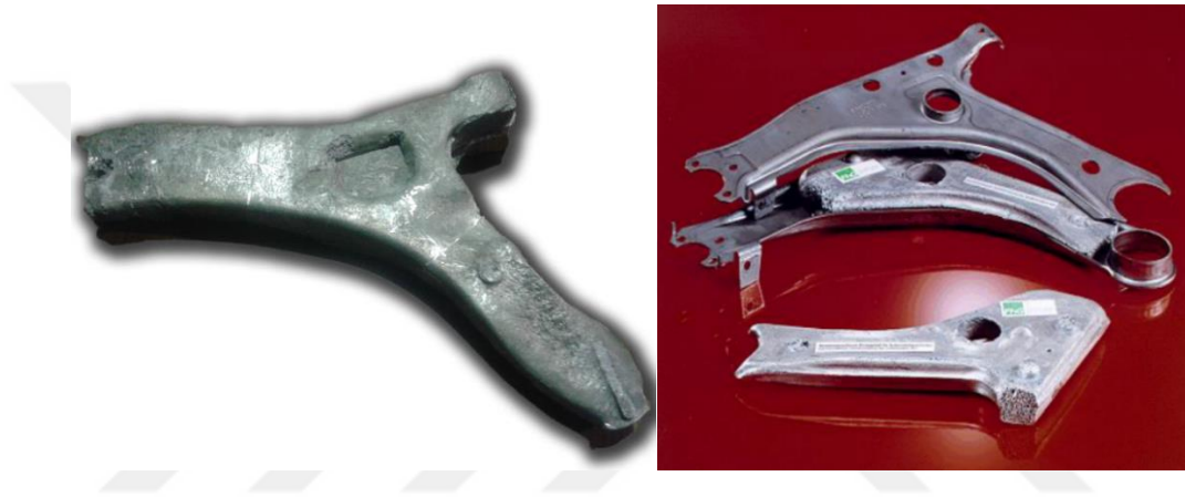
Şekil 5.32. Salıncak kolu ve alüminyum köpük yapısı.
