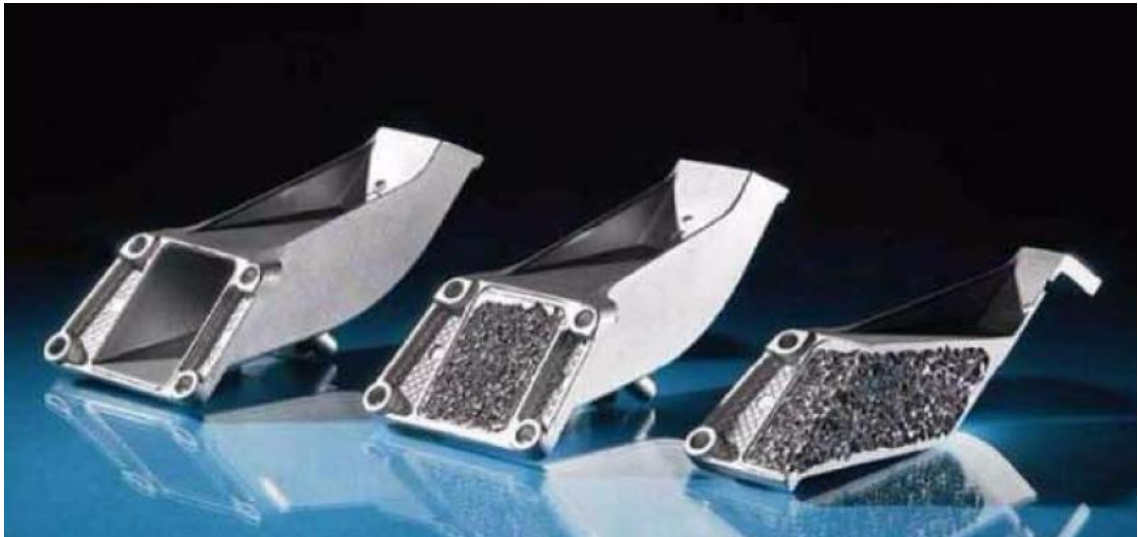
Şekil 5.31. LKR ve BMW'nin geliştirdiği motor blokların sırasıyla; boş, alüminyum köpük içeren parça ve parçanın kesit görünümü (Banhart, 2005).
