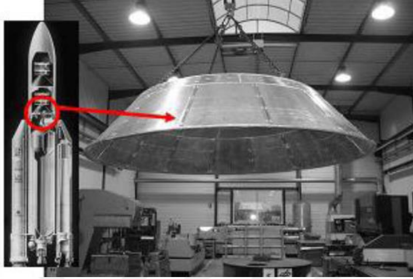
Şekil 5.6. Sandviç köpük panelden üretilmiş roket konisi (Banhart ve Seelinger, 2008).
