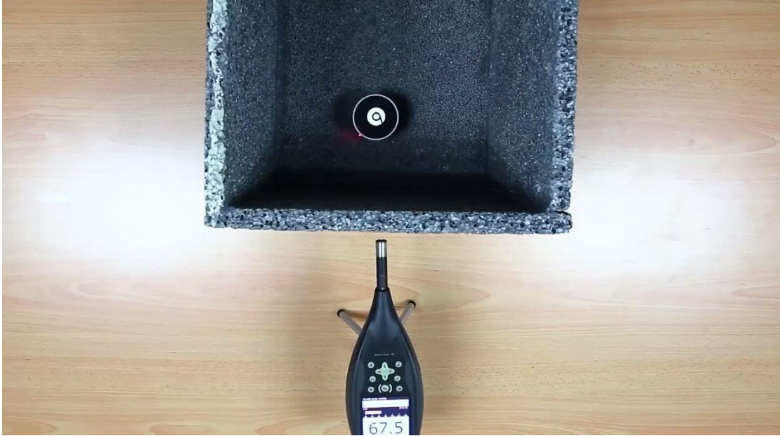
Şekil 6.88. Fortes firmasının alüminyum köpük ile ses analizi.
