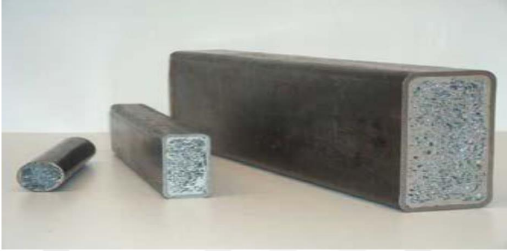
Şekil 4.3. İçi boş profil veya kalıp içerisinde köpürtme (Türker, 2009).
