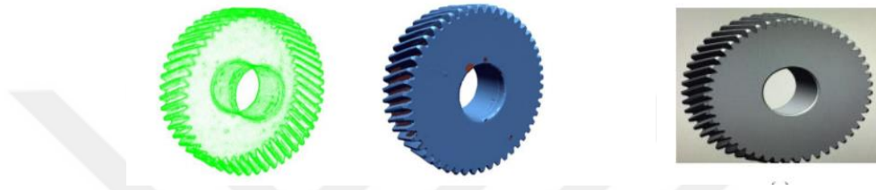
Şekil 2.11. Tarama ile elde edilen nokta bulutu, STL yapı ve sonuç olarak ulaşılan CAD yapı (Şahin vd., 2017).
