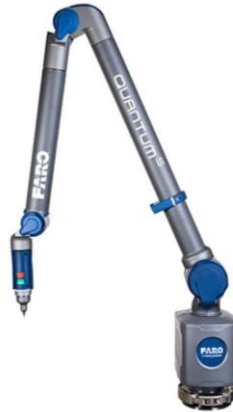
Şekil 2.8. Veri toplamada kullanılan robotik kol (www.faro.com).
