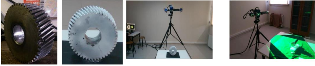
Şekil 2.10. Tarama parçası ve tarama işlemi (Şahin vd., 2017).
