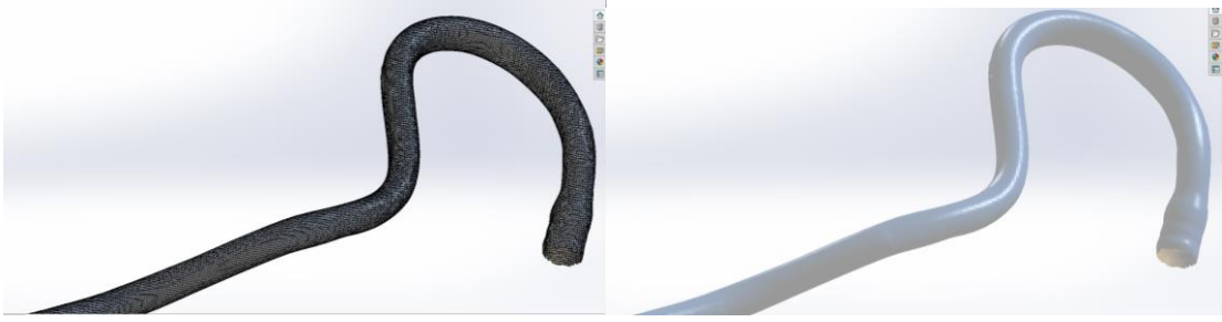
Şekil 3.44. Optik tarama ile elde edilen Mesh'li yapının programa aktarılması.
