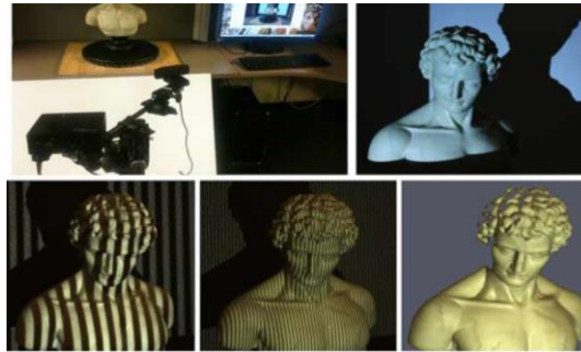
Şekil 2.25. Yapısal ışıklandırma metoduyla tarama.
