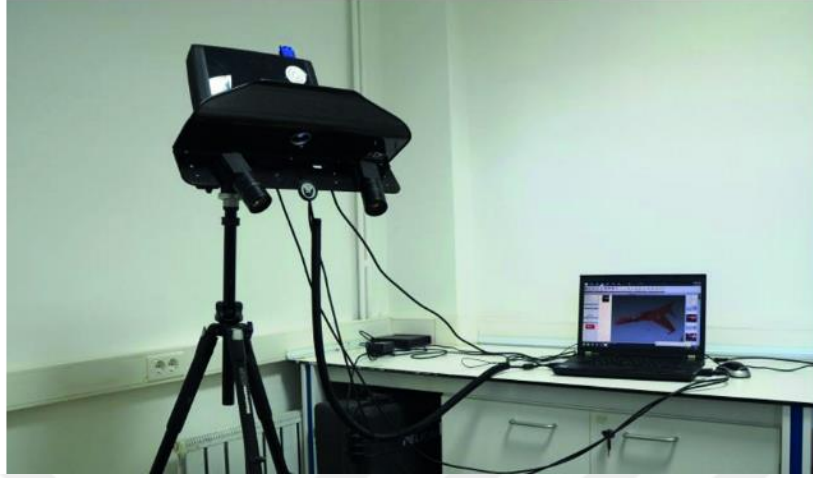
Şekil 3.21. Modelin optik tarama cihazıyla taranması.
