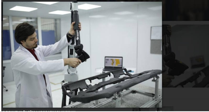
Şekil 3.34. Modelin lazer tarama cihazı ile taranması.
