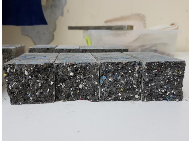
Şekil 6.1: Eğilmede çekme dayanımı sonrası 3KU3 numuneleri.
