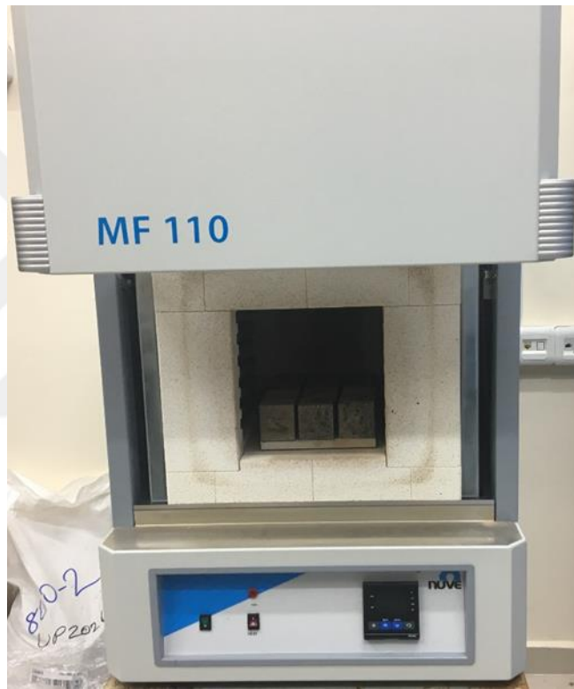
Şekil 5.5: Yüksek sıcaklık deneyi kül fırını.
