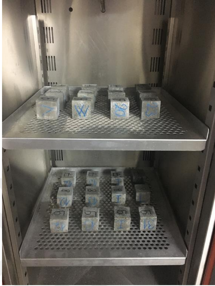
Şekil 5.6: Donma-çözülme deneyi test cihazı.
