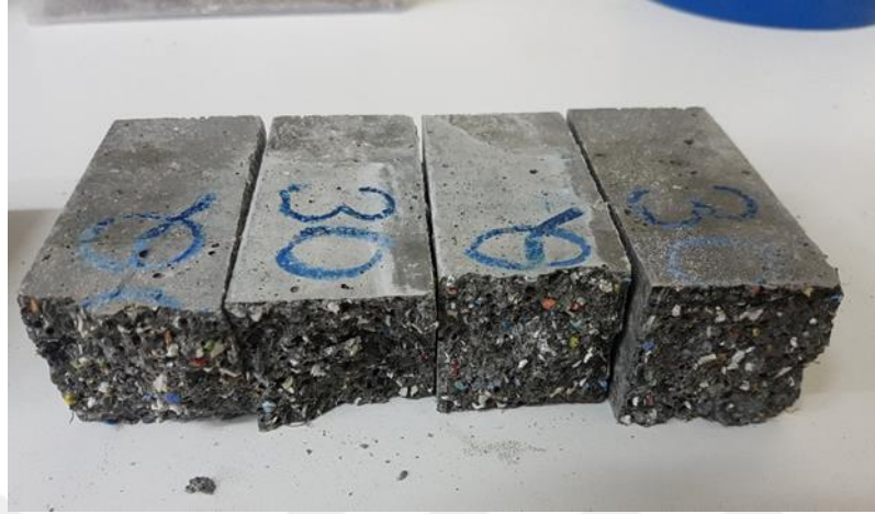
Şekil 6.7: Basınç dayanımı sonrası numune görselleri.
