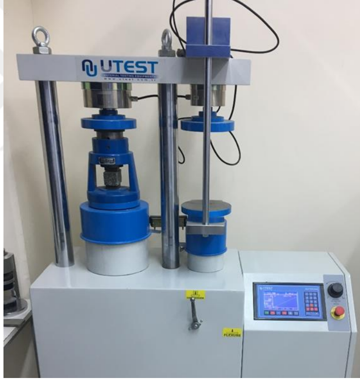
Şekil 5.4: Basınç dayanımı deney düzeneği.
