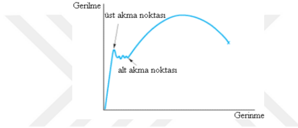
Şekil 1.17: Gerilme-Çekme gerilme grafiğinde akma noktalarının gösterimi
