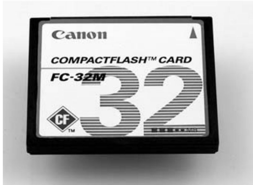
Resim 62: Elde edilen dijital veriler hafıza çiplerine kaydedilir. (Anonim)
