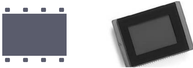
Resim 57: Soldaki fotoğrafta görülen filmin yerini, dijital teknolojiye sensor almıştır. (Anonim)
