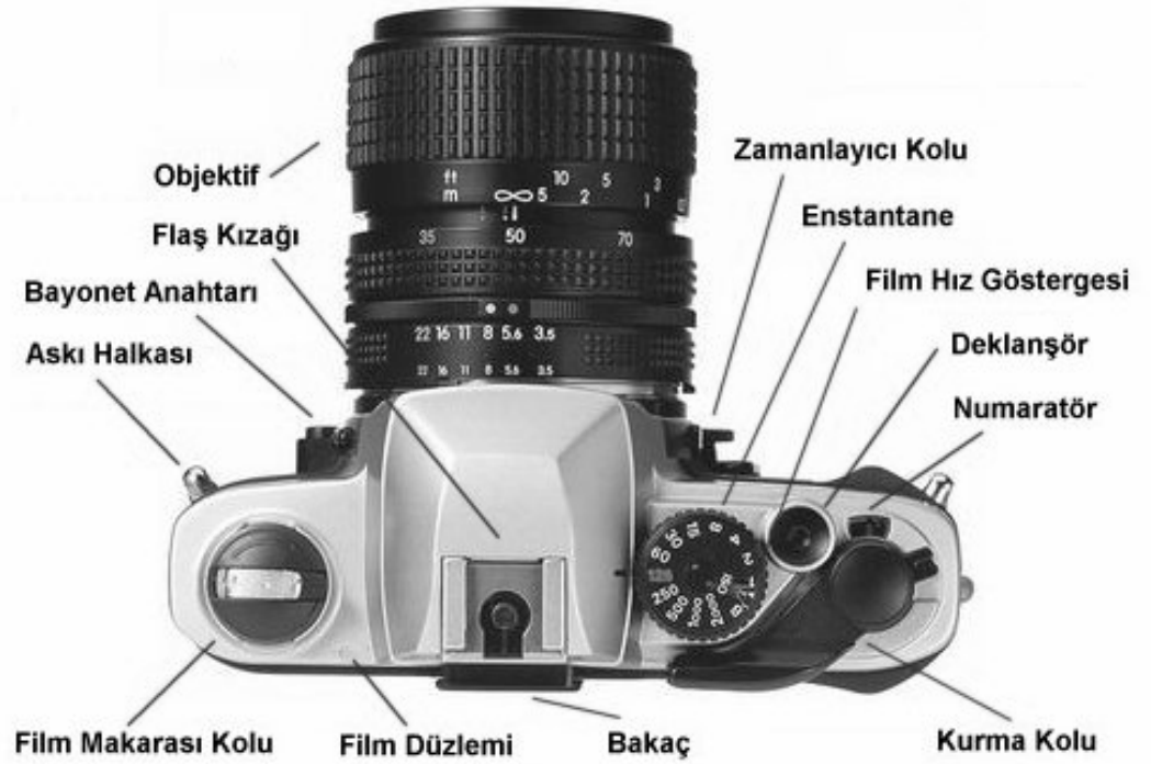
Resim 40: 35 mm'lik SLR makinenin bölümleri. (Anonim)
