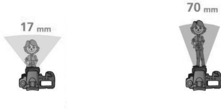
Resim 30: 17 mm. lens: Arka planda daha çok perspektif mevcut 70 mm. lens: Arka plan objeye daha yakın. (Anonim)
