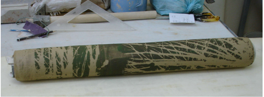
Resim 116. Serigraf baskı yapılmış şamotlu plakanın silindir olarak şekillendirilmesi
