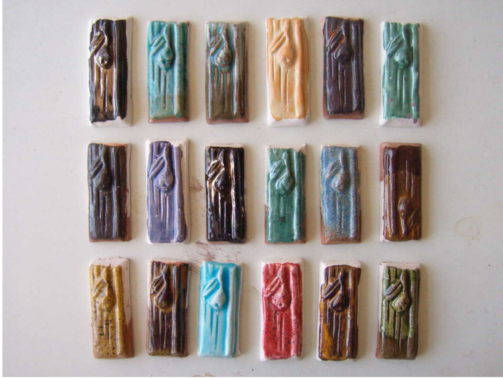
Resim.27: 1040°C’de pişen sır denemeleri.
