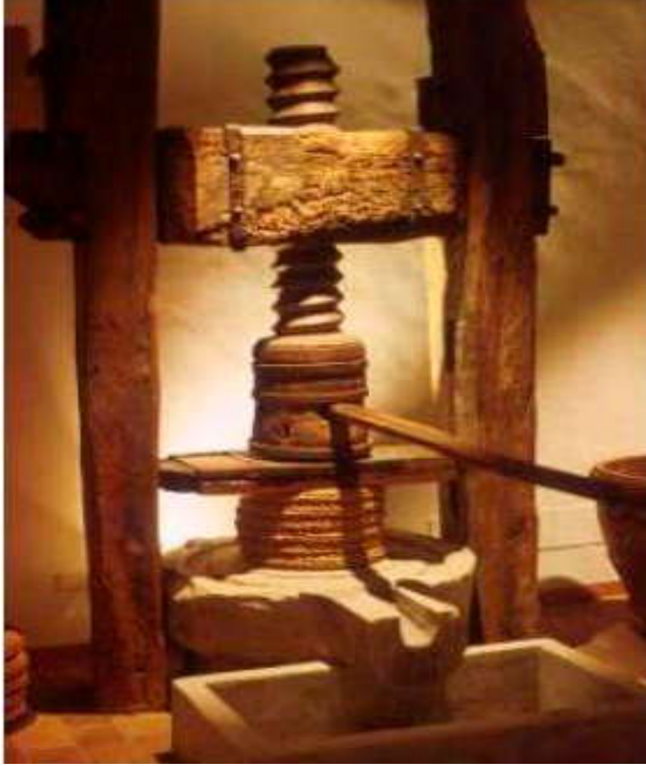
Resim.8: Antik Dönemde Roma 'da Zeytinyağı çıkarmak için kullanılan pres. Lungarotti Müzesi.
