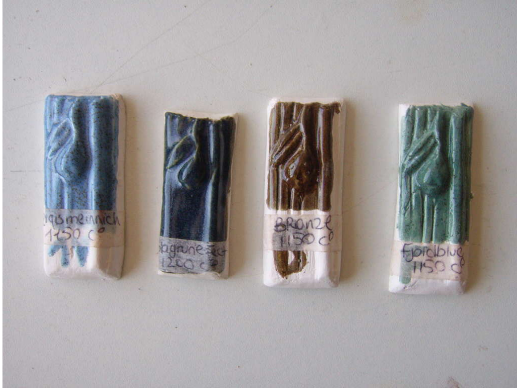
Resim.25: 1150°C’de pişen sır denemeleri.
