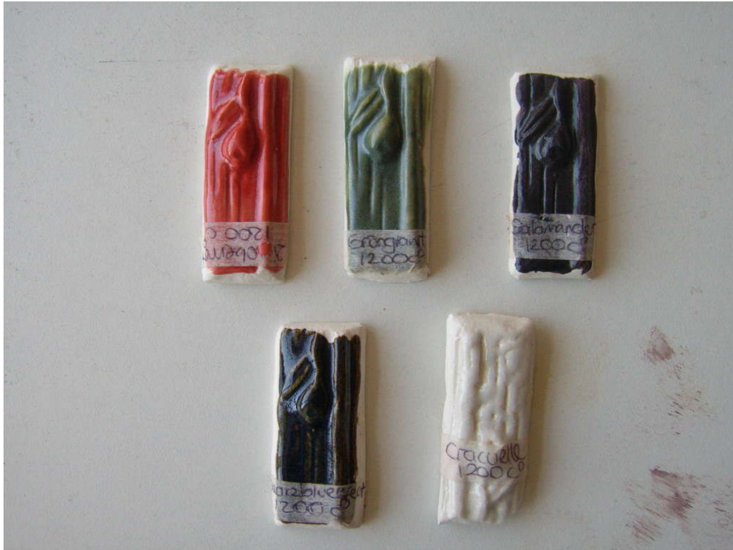
Resim.26: 1250°C’de pişen sır denemeleri.
