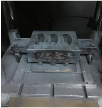
Şekil 6.17: Ön şekillendirme presine tozların konulması.
