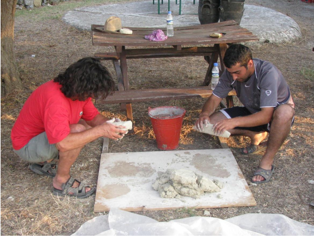
Resim 103: Dinlendirilen Kil Düz Bir Zeminde Çarpılarak Şekillendirilir.
