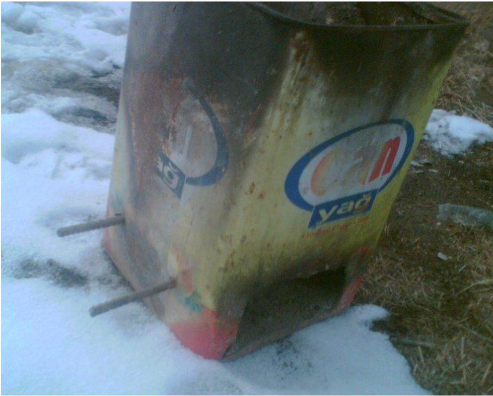
Resim 16: Seyyar Ocak; Tenekeden Yapılır ve Taşınması Çok Kolaydır
