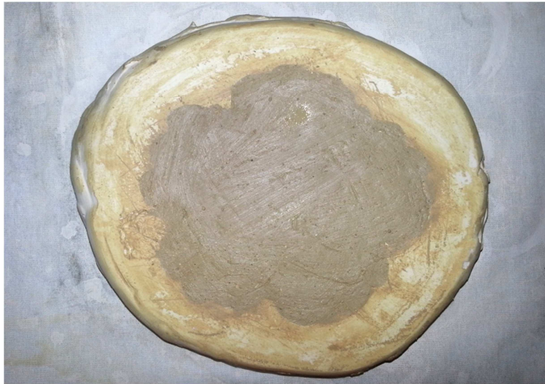
Resim 3.25. Alçı Kalıplara Şamotlu Çamurun Basılarak Şekillendirilmesi Derya Arslan, 2013
