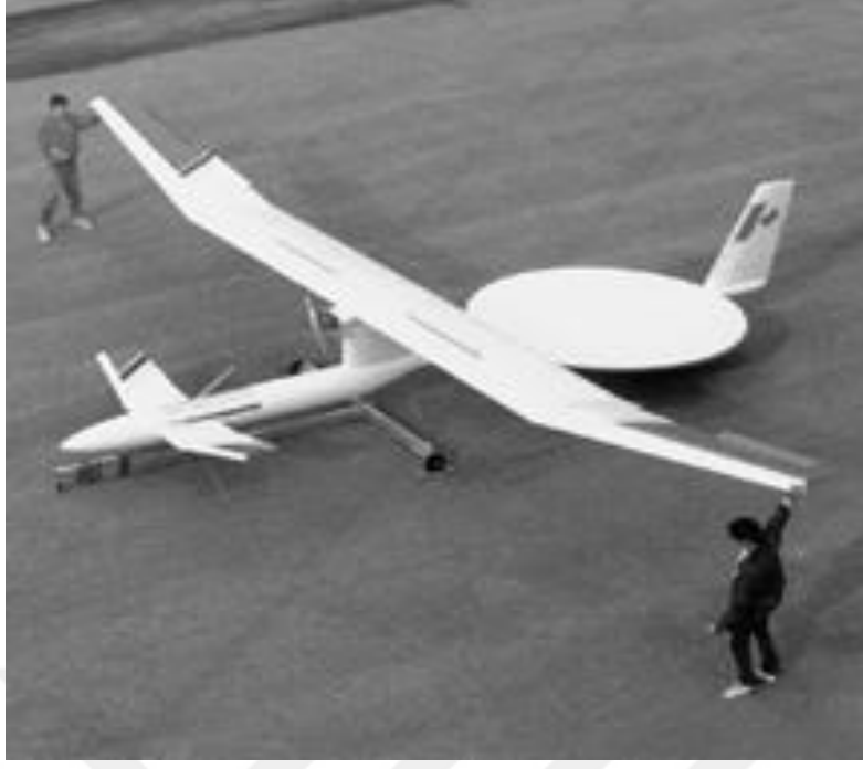
Şekil 1.5: SHARP firmasının mikrodalga enerjisi ile çalışan uçağı [8].
