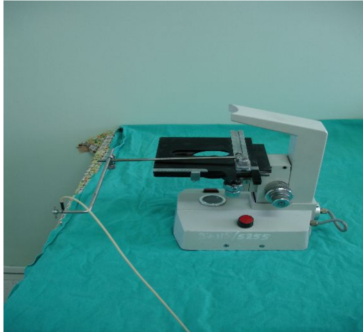
Resim 3.2: Mikroskoptan yapılan prob sabitleyici (Mikromanüplatör)
