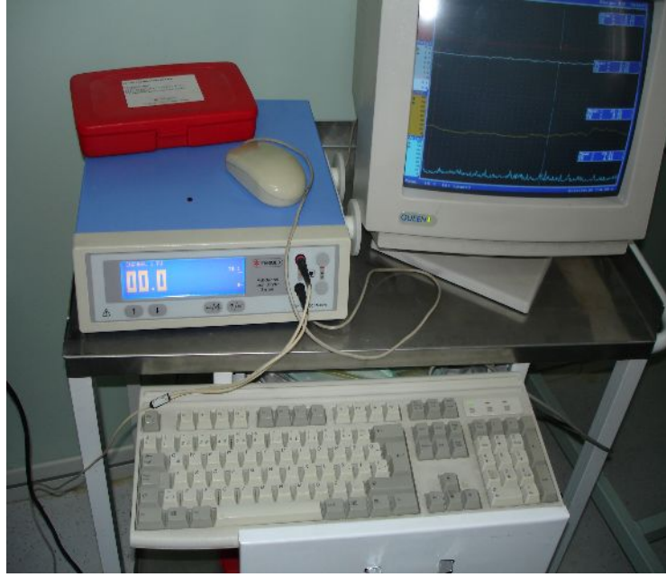
Resim 3.1: Kullanılan LDF Cihazı (Periflux 4001 Master, Perimed) ve bilgisayar-monitör sistemi
