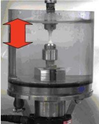
Resim 1 : Statik Diren Özelliklerinin Deęerlendirilmesinde Kullanılan Test Cihazı
