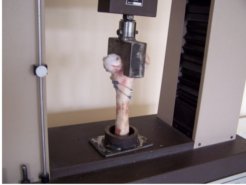
Resim 3.12: ÇDKF yöntemi kompresyon cihaz uygulama görüntüsü
