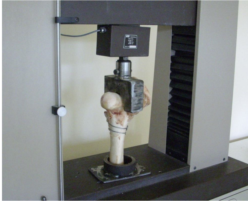
Resim 3.13: SKF yöntemi kompresyon cihazı görüntüsü
