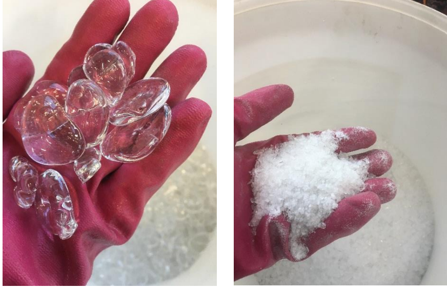
Görsel 5.10. Fırından alınan camlar ve öğütülmüş cam taneleri.
