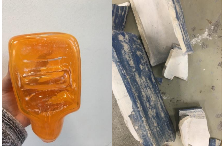
Görsel 5.27. Üfleme sırasında kırılan seramik bünye ve sıcak cam görünümü.
