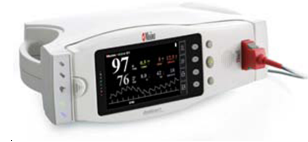
Şekil 2.8. PI değerini Ölçmeyi Sağlayan Monitör
