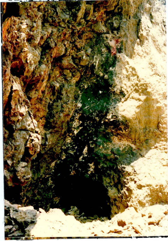
Şekil 3. 9.Çöpler Mangan Yatağında cevherin breşleşmi, kireçtaşı ve granotoyit dokunağında yataklanmış şekli (yarma, G'den K'ye bakış)
