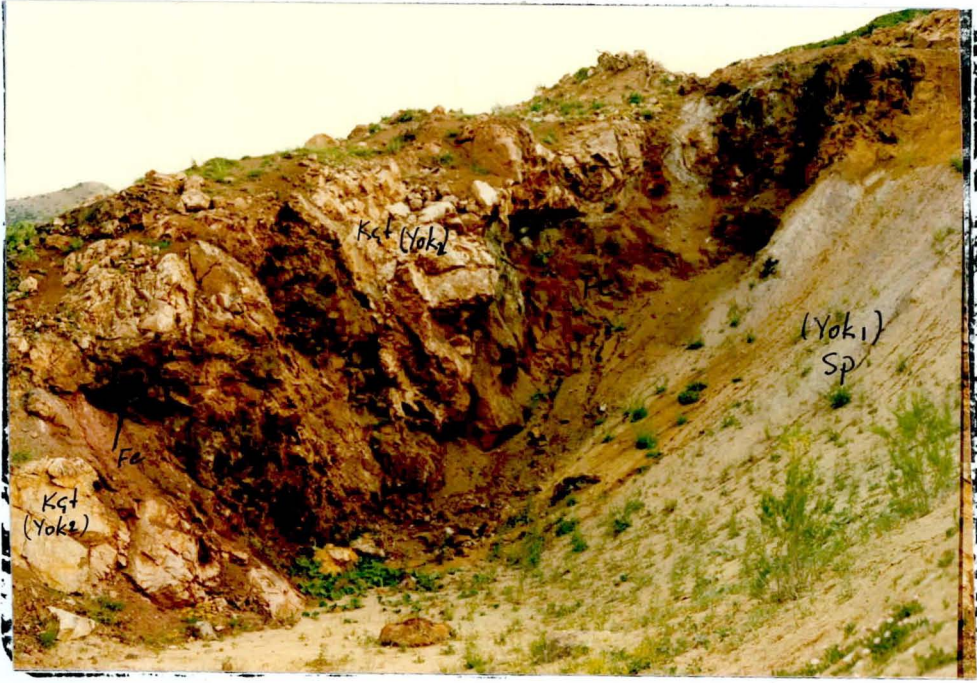
Şekil 3.2. Ağbaba Demir Yatağında cevher yankayaç ilişkisi (KD' dan GB' ya bakış) Kçt: Kireçtaşı Sp : Serpantinit Fe : Demir cevheri (işletilmiş)
