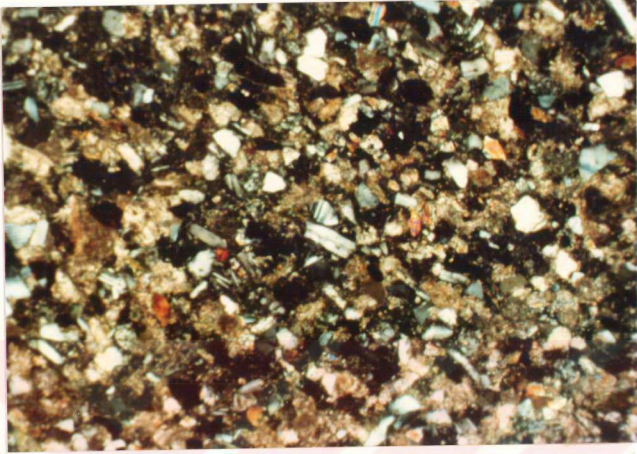
Foto 3.6. Baęlayıcı malzemesi karbonat ve volkanik camdan oluřan kristal kül tüf (40X, ęift nikol)
