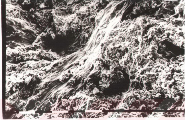
Foto 3.9. Volkanik cam/pomzalarda gelişmiş simektit ve lifsi kloritler (ölçek: 100 nm)
