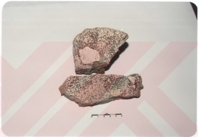
Şekil 3.7 : Karagölistasyonu, Yatağının kuzeydoğu kesiminde izlenen antinodüler (veya negatif) yapıli cevherleşme (Foto, Ki-2, el örneđi).
