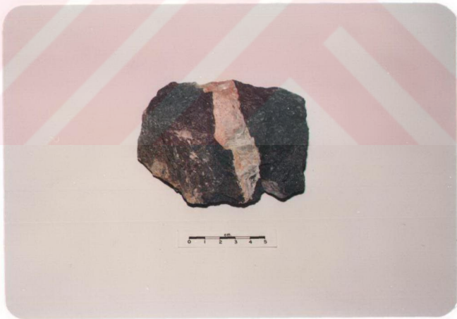
Şekil 2.27: Krom cevherleşmesini kesen ince bir piroksenit daykı (Foto, Karanlıkdere Yatığı, el örneği).
