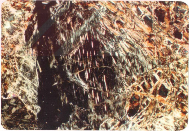
Şekil 2.12: Harzburgitlerdeki ortopiroskenlerin dilinimleri boyunca gözlenen klinopirosken ayrılımları (mikrofoto).
