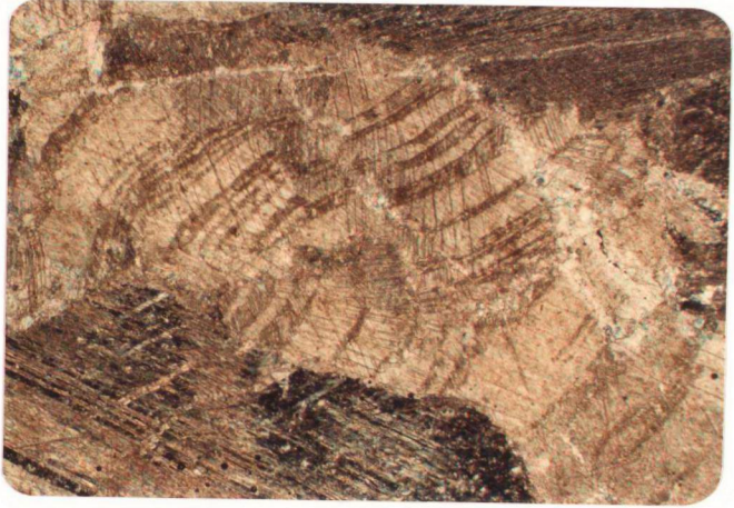
Şekil 2.34: Mermerlerdeki kalsit kristallerinde deformasyon etkisiyle gelişen bükülme ve kıvrılmalar (mikrofoto).
