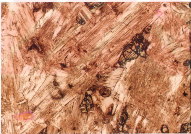
Şekil 3.25a. SY-237/2 no'lu skapolit-fels örneğinde, skapolit mineralinin optik eksene paralel geçmiş olan kesitinin; a) çift nikoldeki, b) tek nikoldeki görünümü (skp, skapolit).
