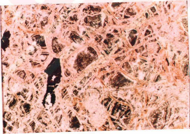
Şekil 3.3. SY-187 no'lu serpantinli örneklerdeki ağ dokusu gösteren serpantinleşmenin; a) çift nikoldeki, b) tek nikoldeki görünümü.
