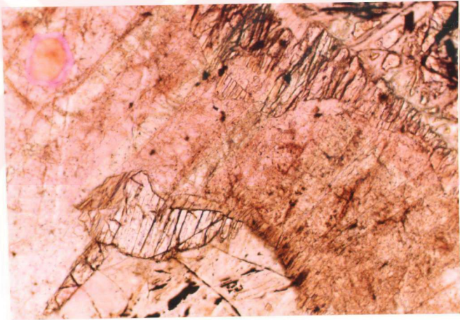
Şekil 3.9. SY-42 no'lu gabro örneğinde, piroksen minerali ile plajiyoklaz minerali arasında gelişen reaksiyon kuşağının(kr, korona); a) çift nikeldeki, b) tek nikeldeki görünümü.
