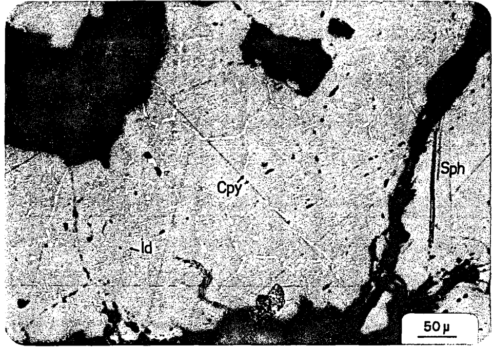
Sekil 3.12: Sfalerit kristallerini kenarları boyunca kuşaktan ağsı görümlü kalkopirit dolguları (mikrofoto)
