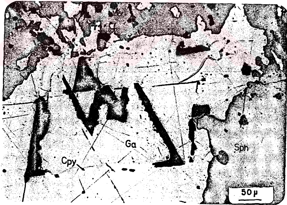
Sekil 3.16: Galenitlerin dilinim düzlemleri boyunca oluşmuş kalkopirit kristalleri (mikrofoto) Çekim : Parlatma, tek nikol, hava ortamı Büyütme : 200X Örnek No: 13 Ga: Galenit, Cpy: Kalkopirit
