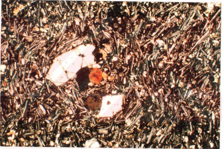
Şekil 9. Oligosen (?) yaşlı Taşbulak formasyonun en üst kesimlerinde izlenen olivin bazaltların ince kesit görünümü (çift nikol).
