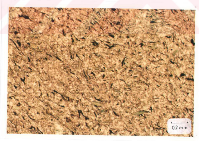
Şekil 3.20. Armutludere formasyonu arduvazlarında kaba sleyt klivajı, (tek nikel, örnek no:TTB-232).
