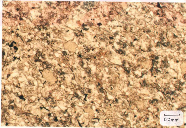
Şekil 3.22. Armutludere formasyonu metasilttaşlarında klorit-mika istifleri, açık kahverengi neoforme klorit ve detritik mikalar (tek nikol, örnek no:TTB-243).
