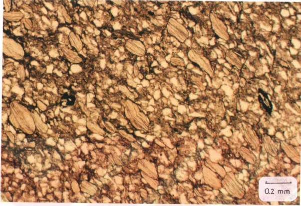
Şekil 3.21. Armutludere formasyonu metasilttaşlarında klorit-mika istiflerinin oluşturduğu mikroyönlenme (tek nikol, örnek no:TTB-237).
