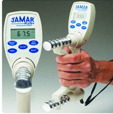
Şekil 3.1.2 JAMAR PLUS+ el dinamometresi ile ölçüm
