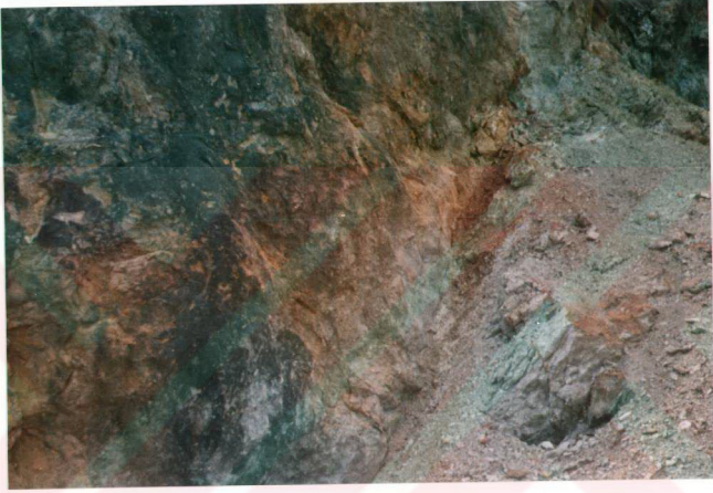
Şekil 3.1. KB-GD doğrultulu kırık zonu ile ilişkili olarak silisleşmiş ve limonitleşmiş kireçtaşları (Karlıdoruk Tepe güneydoğu etekleri).
