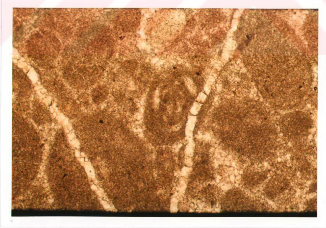
Şekil 2.20. Hacıpınarı Formasyonu içindeki sparitik çimentolu ve kalsit damarlı kireçtaşlarının mikroskopik görünümü. Çekim: İncekesit, tek nikol, büyütme: 100X
