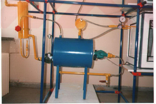
Fotoğraf 7. Kondenser ve evaporatör arasındaki soğutucu eşanjörün görünümü
