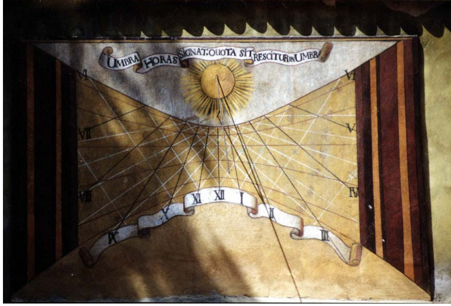
Şekil 2.3.6 Çek Cumhuriyeti'nde yer alan Güney yönelimli dikey kadranlı bir Güneş saati. Kadran, ufuk düzlemine dik bir düzlemdir.
