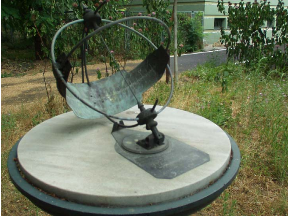
Şekil 2.3.1 İstanbul Üniversitesi’nde yer alan kutup Güneş saati. Dikkat edilirse kadransilindiriktir.
