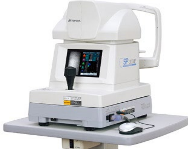
Şekil 5: Speküler mikroskopi cihazı
