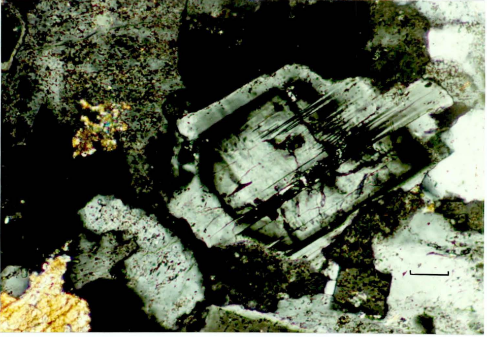
Şekil 4.19. Büyüklök monzograditindeki plajiyoklazlarda gelişmiş olan zonlu doku ile polisentetik ikizlenmenin birlikte gözlenmesi (Çift nikol, çizgisel ölçek, 0.045mm, TE-29).
