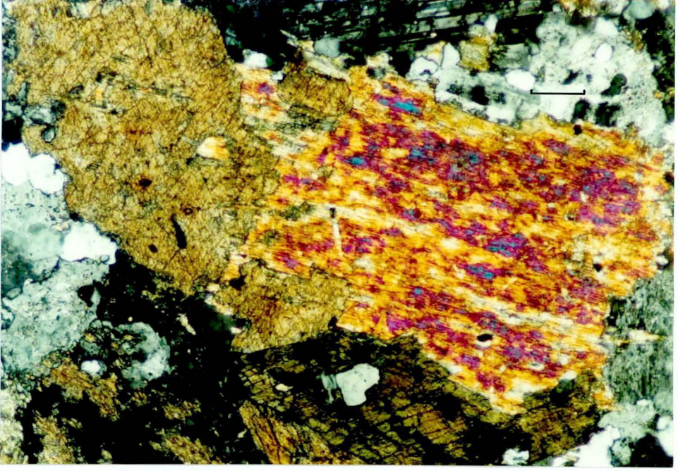
Şekil 4.12 Lökkyö K-feldispat megakristalli monzogranitinde hornblendin tremolit/aktinolit mineraline dönüşümü (Çift nikol, çizgisel ölçek: 0.11mm, TE-5).
