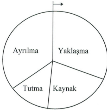
Şekil 3.3. Kaynak çevriminin safhaları (Apps, 1970)
