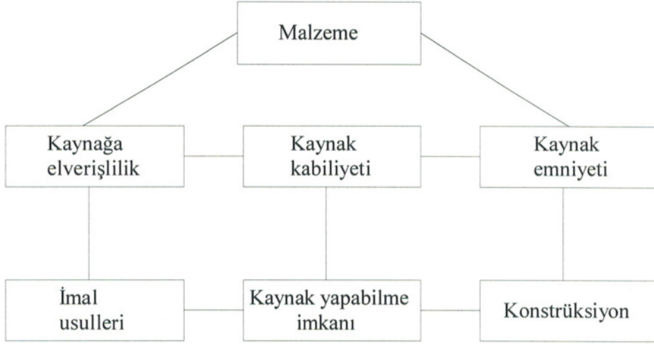
Şekil 2.3. Kaynak kabiliyetinin malzeme, imal usulü ve konstrüksiyona bağlı olarak ifade edilmesi (Anık, 1983)
