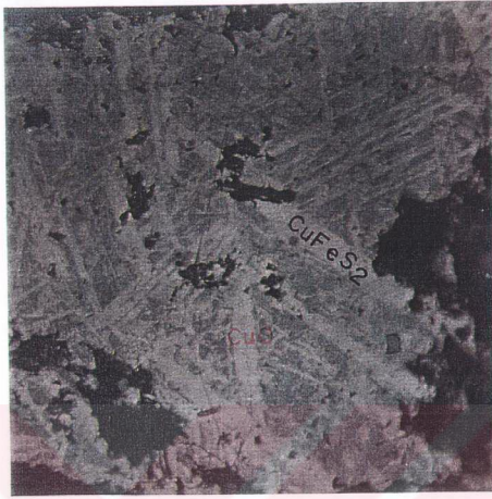
Resim1. Kalkopiritler ( \text{CuFeS}_2 ) Üzerinde, Yüksek Sıcaklık Koşullarında Gelişmiş Tenoritler ( \text{CuO} ). Büyültme: 50X
