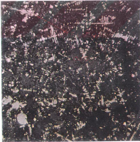
Resim 2. Tenorit ( \text{CuO} ) İçerisinde Yüksek Sıcaklık Koşullarında Gelişmiş İskelet Manyetit ( \text{Fe}_3\text{O}_4 ) Oluşumları. Büyültme: 50X
