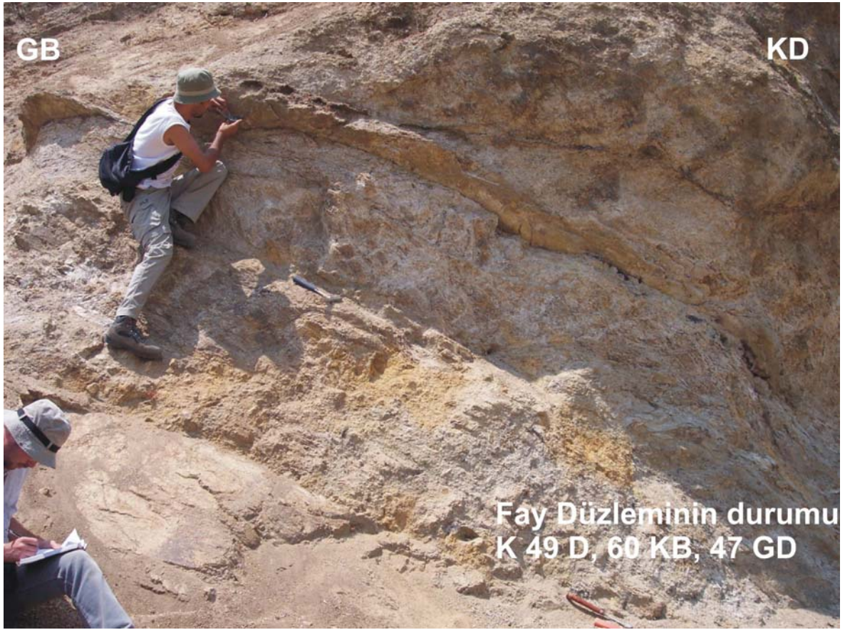
Şekil 4.7. Çakmak köyü güneybatı girişinde gözlenen bir ters fay (UTM Koordinatları: 61.024-38.578) (GD'dan KB'ya bakış).
