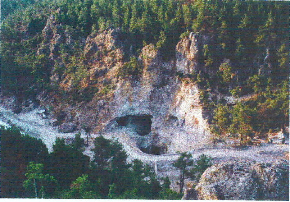
Şekil 3.2. Tahtalıkuyu yatağının galeri girişi (solda) ve stockwork tipi cevher kesiminin alındığı işletme yarması (İkinci viraj yatağından kuzeye bakış).
