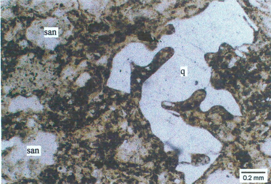
Şekil 2.17. Adadağı piroklastiklerine ait riyolitik camsı kül tuf örneğinde (KR-323) silisleşmiş volkan camı içerisinde kemirilmiş kuvars kristallerinin ince-kesit teknikol görünümü (q: kuvars, san: sanidin).
