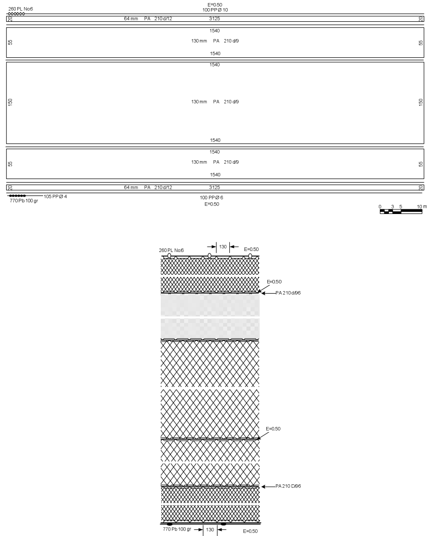
Şekil 20. Torik uzatma ağının teknik planı ve kesiti.
