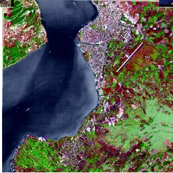
Şekil 4.1 a) IHS; b) Brovey; c) Ehlers dönüşümleri yardımıyla belirginleşen Boğaz akıntısı
