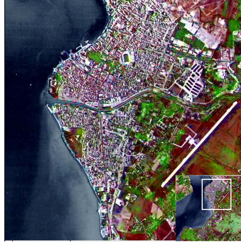
Şekil 3.13d Çanakkale Kent Merkezinin Ehlers Dönüşüm Modeli yöntemiyle karılarak oluşturulmuş görüntüsü
