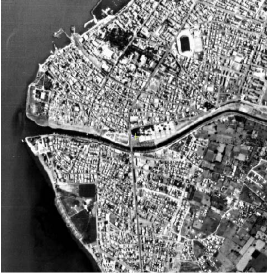
Şekil 3.18a Şekil 3.15a'daki orjinal görüntü üzerinde alçak geçirgen filtreleme işleminden sonraki genel görünüm
