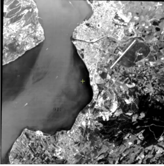
Şekil 3.18a Şekil 3.15a'daki orjinal görüntü üzerinde alçak geçirgen filtreleme işleminden sonraki genel görünüm
