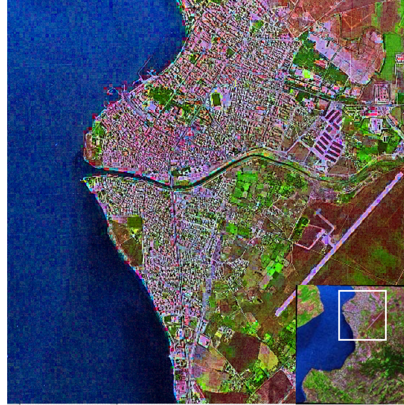
Şekil 3.22d Karılmış görüntünün (Şekil 3.22c) yüksek frekanslar toplamı ile tekrar karılarak zenginleştirilmesi
