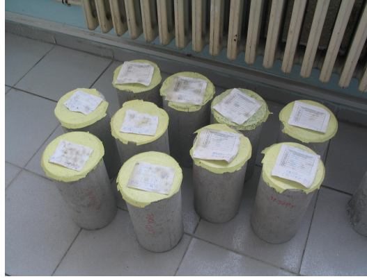
Şekil 30. Kükürtle başlıklanmış bir kısım silindir beton örneği
