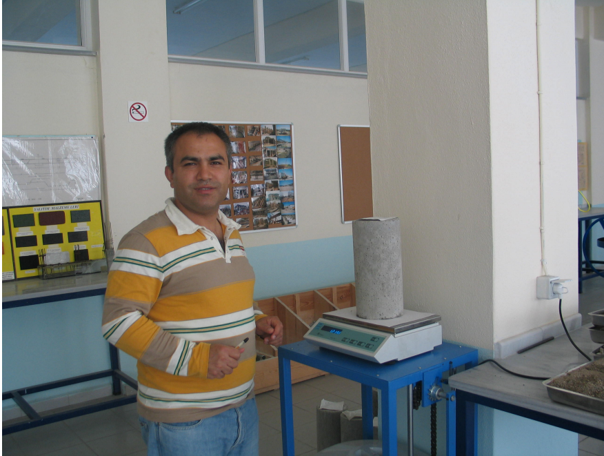
Şekil 24. Birim ağırlıkların belirlenmesi için silindir numunelerin tartılması
