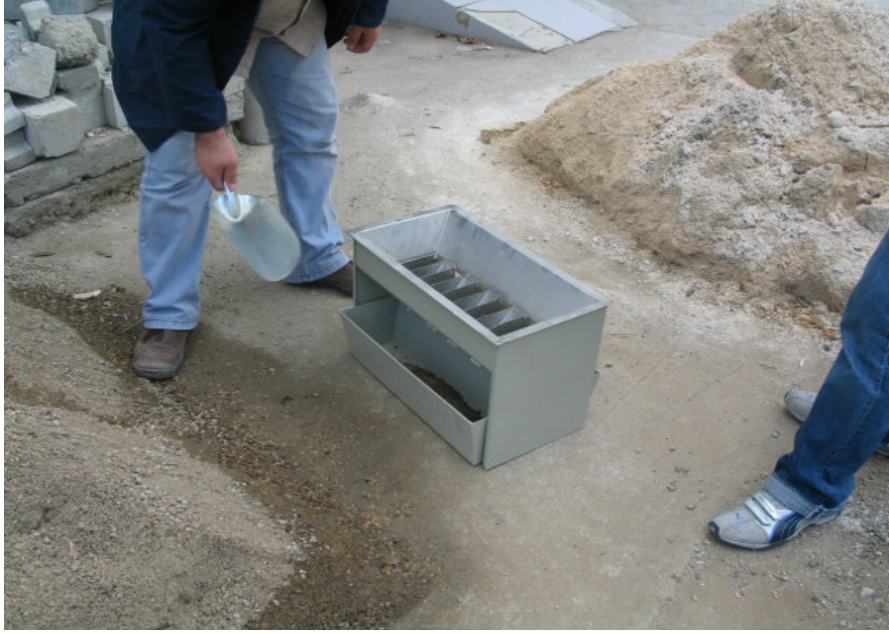
Şekil 4. Bölgeç ile numune azaltılması
