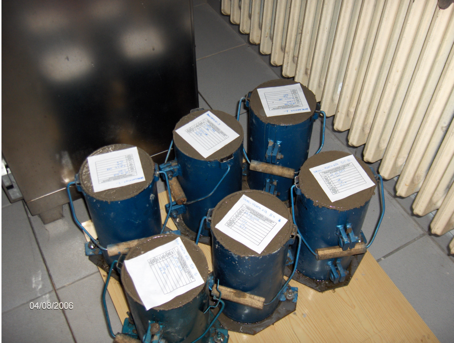
Şekil 19. Taze beton örneklerinin etiketlenmesi
