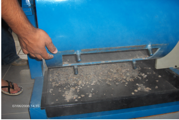
Şekil 12. Los Angelas aşındırma cihazı (Bilyeli tambur)
