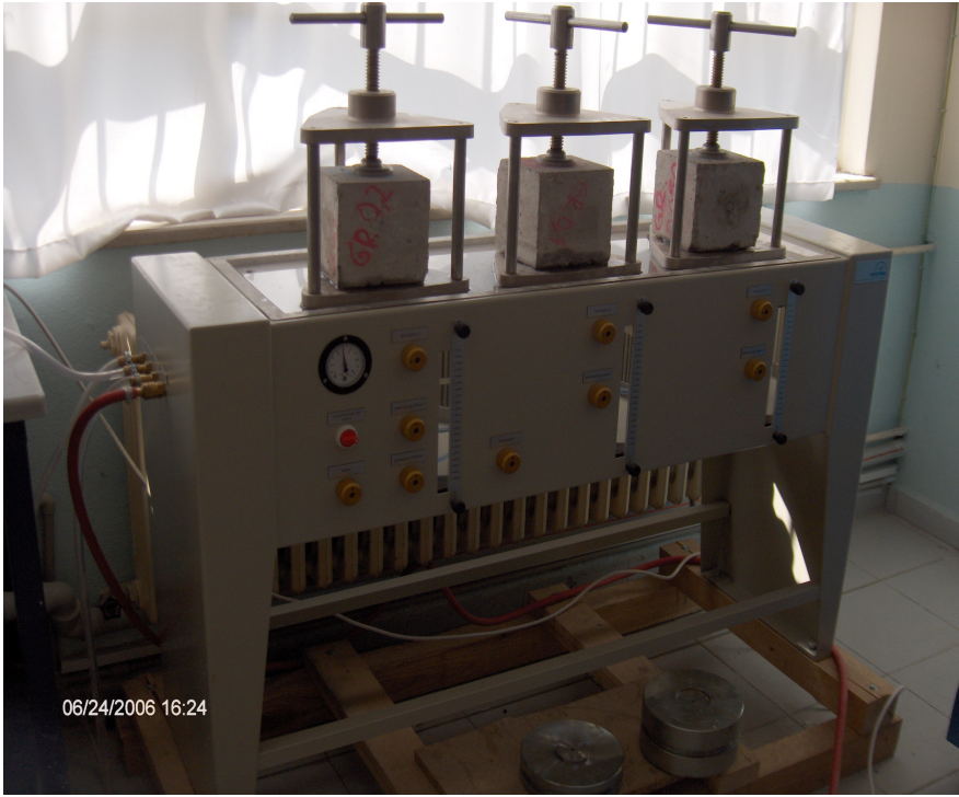
řekil 25. Permeabilite cihazına baęlanmıř numuneler
