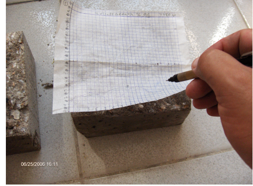
Şekil 27. Su işleme derinliğinin belirlenmesi
