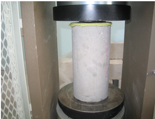
Şekil 31. Beton presinde, başlıklanmış silindir numune
