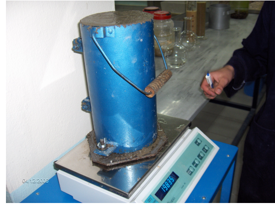
Şekil 21. Birim hacim ağırlıklarının bulunması için tartım yapılması.
