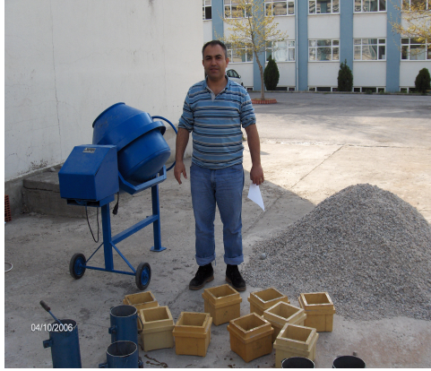
Şekil 14. Beton dökümüne hazırlık, numune kalıpları ve betoniyer
