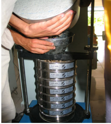
Şekil 5. Elek serisinden numunelerin elenmesi
