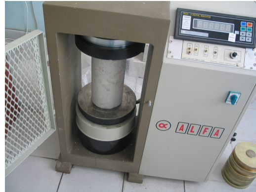
Şekil 32. Beton basınç test presinde silindir örneğin kırılması
