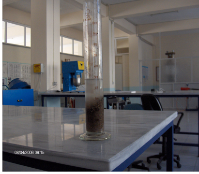
Şekil 7. Özgül ağırlığın bulunması
