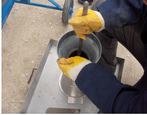
Şekil 16. Slamp hunisine numunenin yerleştirilmesi
