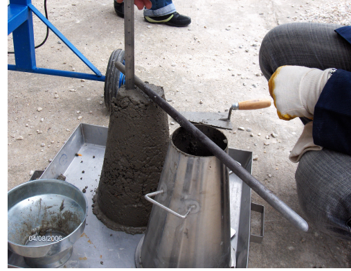
Şekil 17. Kıvamın belirlenmesi için ölçme
