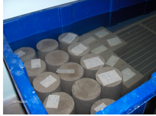
Şekil 29. Kür havuzlarında numunelerin olgunlaşması
