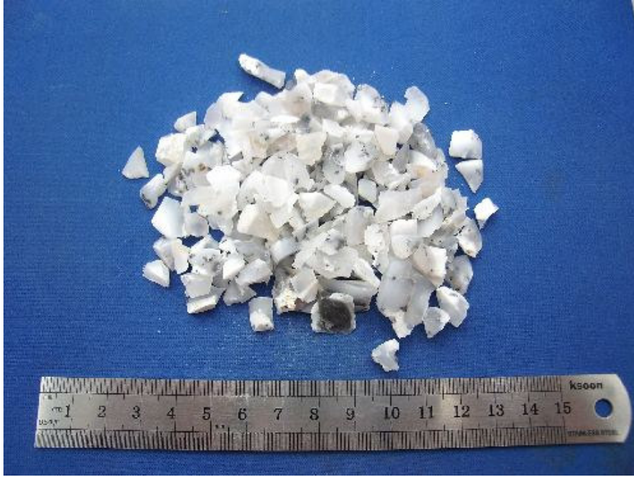
Şekil 3-8. Transparan zondan XRD analizi için hazırlanan örnekler.
