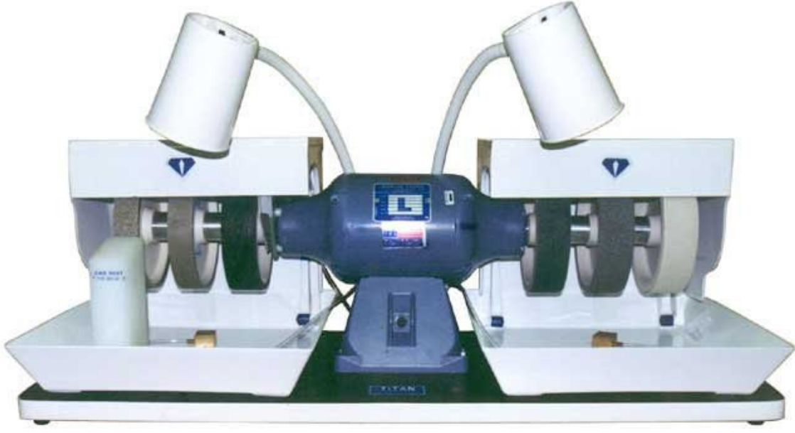
Şekil 4-7. Kabaşon işleme makinası.
