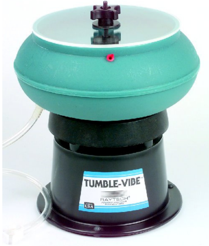
Şekil 4-9. Vibrasyonlu tanbur makinası.
