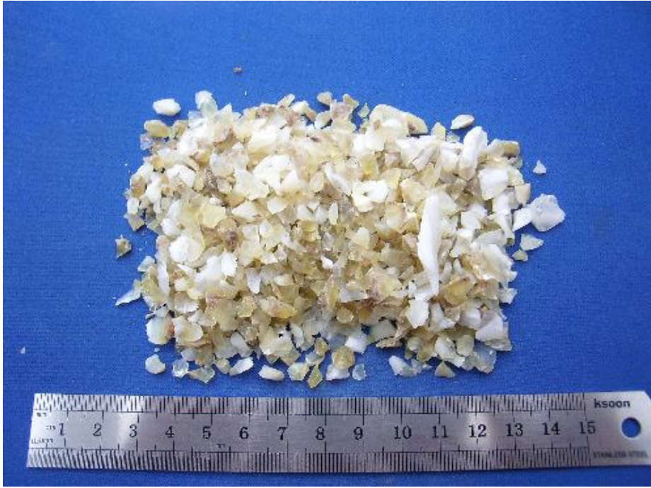
Şekil 3-10. Opalli zondan XRD analizi için hazırlanan örnekler.
