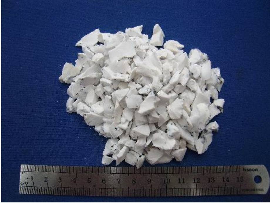
Şekil 3-4. Beyaz zondan XRD analizi için hazırlanan örnekler.
