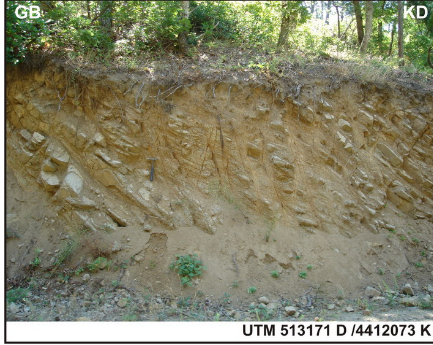
Şekil 3.8. Ilıcabaşı Tepe 400 m KB sında granodiyoritlerde gözlenen çatlak sistemleri.
