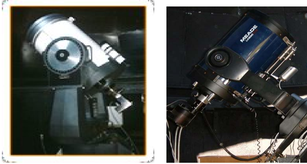
Şekil 2.2 Cassegrain-Schmidt Tipi 40cm ve 30cm Meade LX200 Teleskopları
