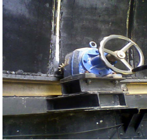
Şekil 5.5 Otomasyon Öncesi Kubbeyi Döndüren Dişli Sistemi
