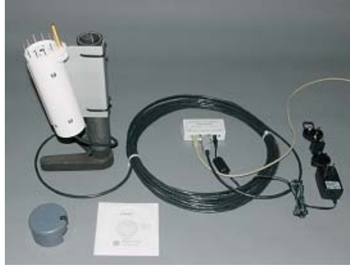
Şekil 4.3 Boltwood Cloud II Sensörü [3]
