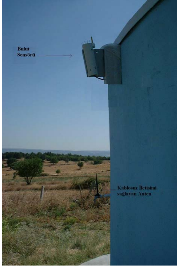
Şekil 5.8 T30A Kubbesinde Bulut Sensörü ve Kablosuz İletişim Anteni
