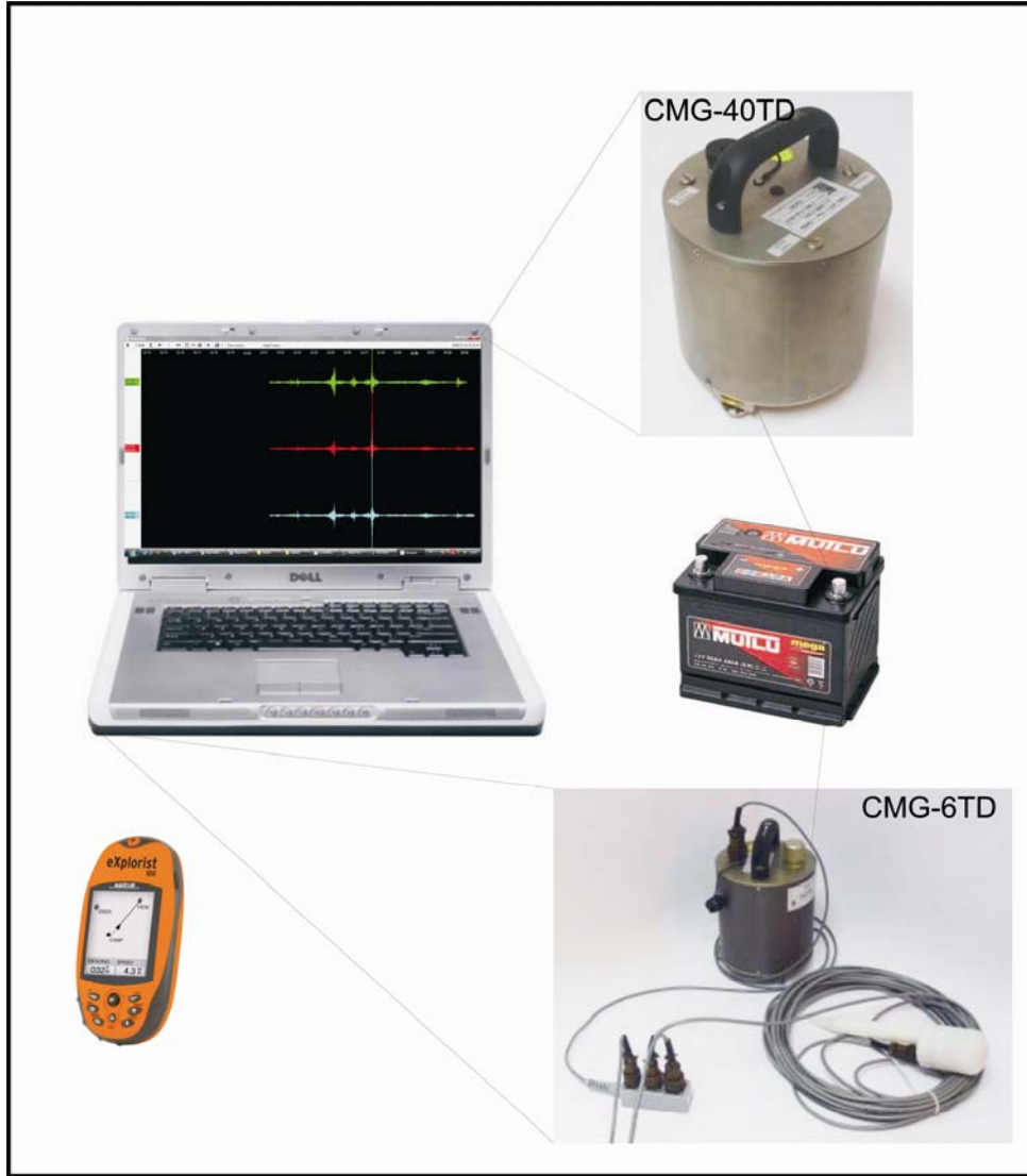
Şekil 19. Mikrotremor Arazi Ölçüm Ekipmanı
